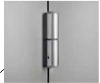
**Cerniere:** in alluminio anodizzato, fissate nello spessore del pannello, dotate di dispositivo a molla al fine di programmare l'apertura o la chiusura automatica del battente.
